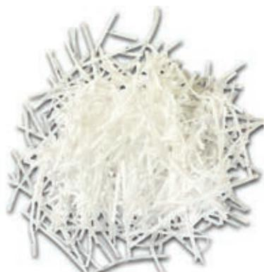
Фильтрующее волокно для фильтрации и сбора нефтепродуктов. Не требует монтажа фильтрационных установок. Эффективный сбор при минимальном течении, не требует принудительного усиления скорости потока, в отличии от фильтрующих установок.
